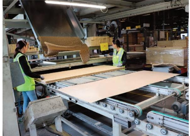
Les éléments d'huissierie et les portes parviennent de part et d'autre de la ligne de montage. Ils sont positionnés manuellement avant cadrage (mise en bois). Le cadrage et le vissage des montants et traverses sont automatisés.
