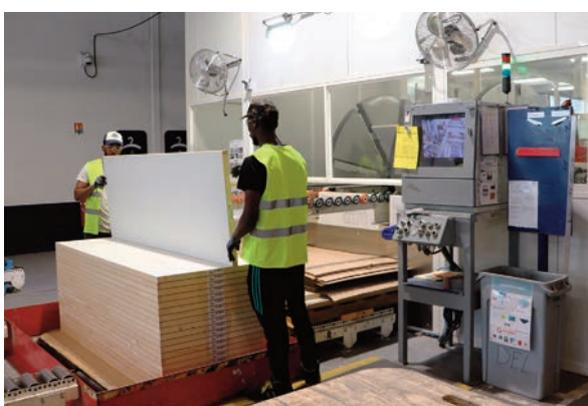
Retournement et empilage manuels, qui permettent un contrôle visuel de la qualité de l'usinage sur les deux faces et les chants. L'automatisation de cette étape est à l'étude.
