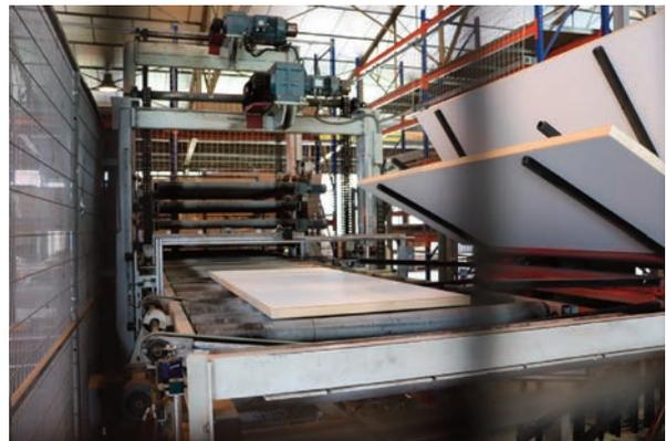
En fin de pressage, les portes refroidissent dans ce stock tampon, avant leur empilage, automatique.
