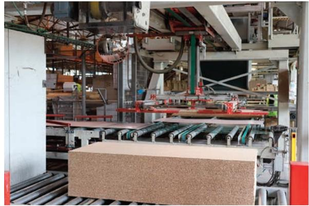
Les deux panneaux composant la porte sont évacués et un retournement automatisé permet de les assembler en sandwich.
