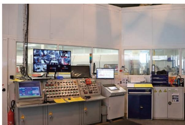
Supervision par caméra des actions intervenant dans la cabine. La déligneuse est composée de deux machines travaillant successivement la porte dans sa longueur et dans sa largeur : mise à dimensions de la porte, profilage des chants.
