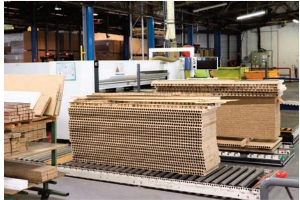
Stockage des parements de portes et des âmes (en aggloméré plein ou alvéolaire, polystyrène, etc., selon le modèle à fabriquer).
