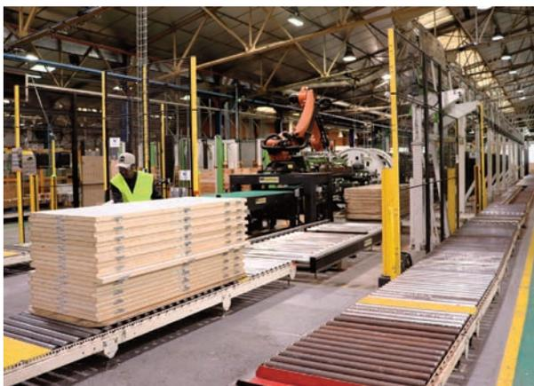
Les deux lignes d'entaillage comptent quatre machines pour l'usinage et la pose de la quincaillerie, et deux robots, en entrée et sortie de ligne. L'ensemble est automatisé.
