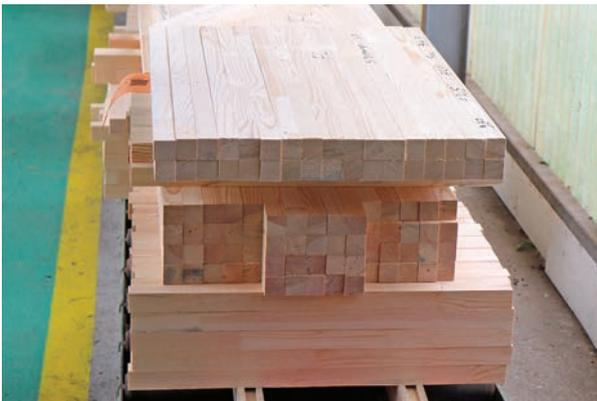
Les traverses et les montants utilisés pour fabriquer les cadres de portes sont convoyés vers les postes d'agrafage du cadre.
