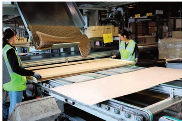
Puis le cadre. Première phase de cadrage : cadre panneaux et âme sont positionnés et maintenus en place par quelques points de colle avant leur convoyage vers la presse.
