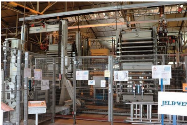
Ici l'une des deux presses, à deux chambres : les quatre cages peuvent contenir cinq portes chacune, qui sont mises en compression pendant 180 secondes sur les plateaux chauffés à 70 °C (la pression exercée varie en fonction du type d'âme).
