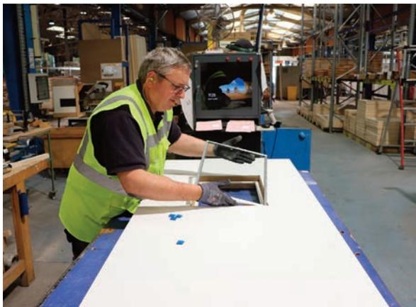
Le poste de parachèvement, avec un exemple de personnalisation : la pose d'un vitrage dans un oculus. Les portes destinées à être vendues avec leur huisserie (blocs-portes) sont dirigées vers la zone d'assemblage.
