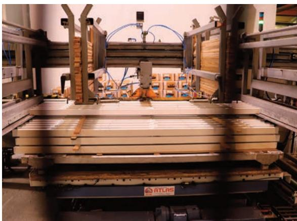
Le tout est automatisé, y compris l'empilage, le dépilage et le convoyage. De futurs investissements sont envisagés pour une nouvelle ligne d'entaillage huisseries, qui sera installée à proximité de la ligne d'assemblage, de façon à limiter la manutention.
