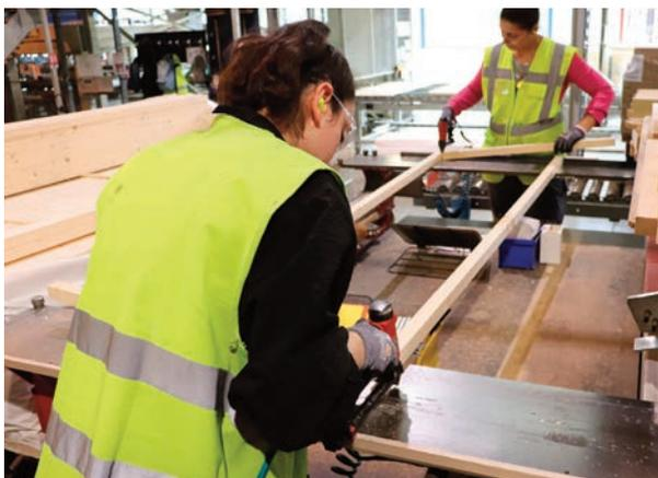
Quatre lignes de fabrication, spécialisées dans l'usinage et la pose de diverses quincailleries (paumelles, gâches, fiches).
